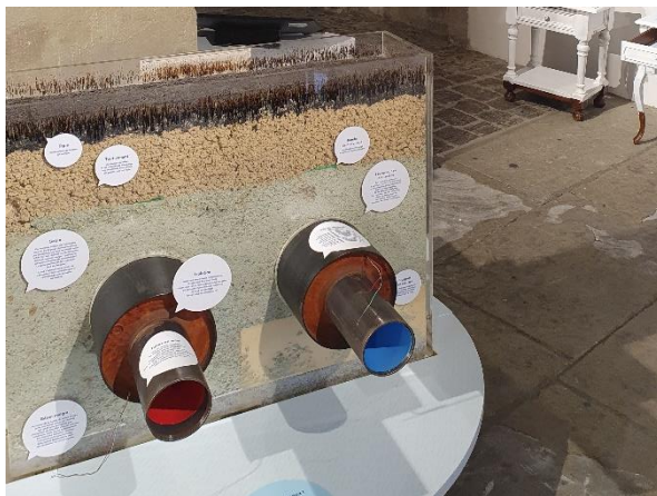
Figure 7 Maquette de chauffage à distance (à g.) et arbres à engagements (à d.)
